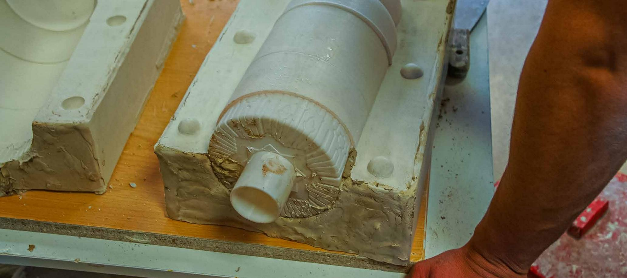
Una vez el diseño de la lámpara quedó realizado, **se imprimió un prototipo** a escala aumentada para contrarrestar el encogimiento de la cerámica.
