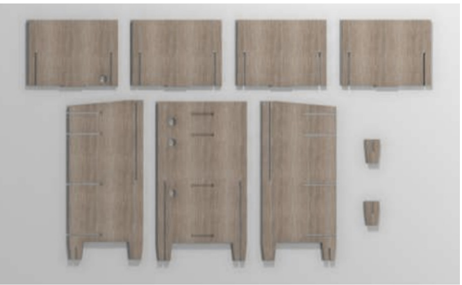
Figura 16. Despiece mueble tocadiscos Cross sin necesidad de tornillería.
